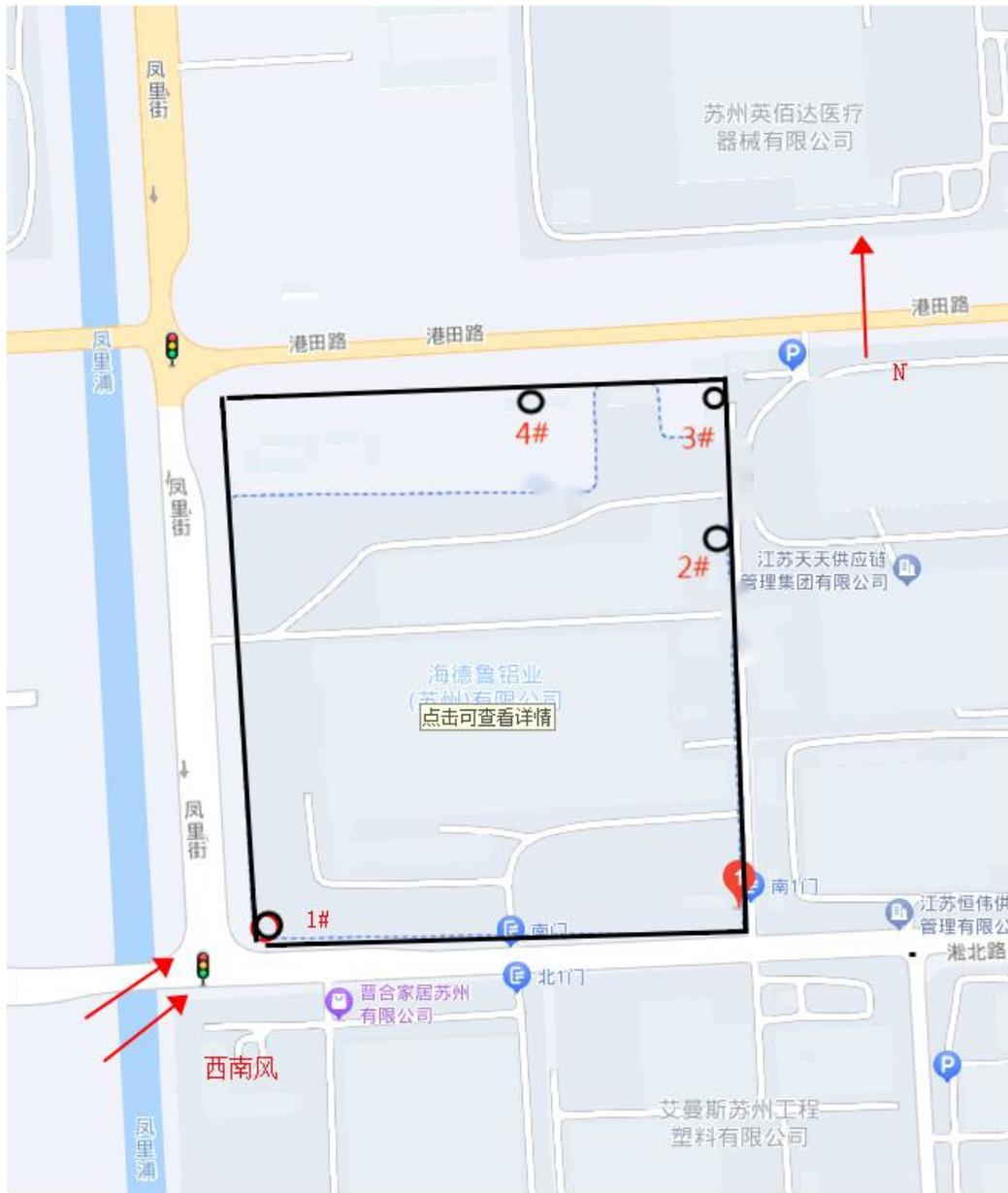
“○” 表示无组织废气检测点
