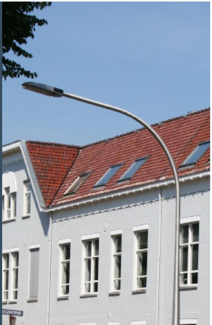
In Situationen, in denen sich der Lichtmast in einiger Entfernung von der Straße befindet, bietet ein Auslegermast die Möglichkeit, den erforderlichen Lichtbedarf zu realisieren.
